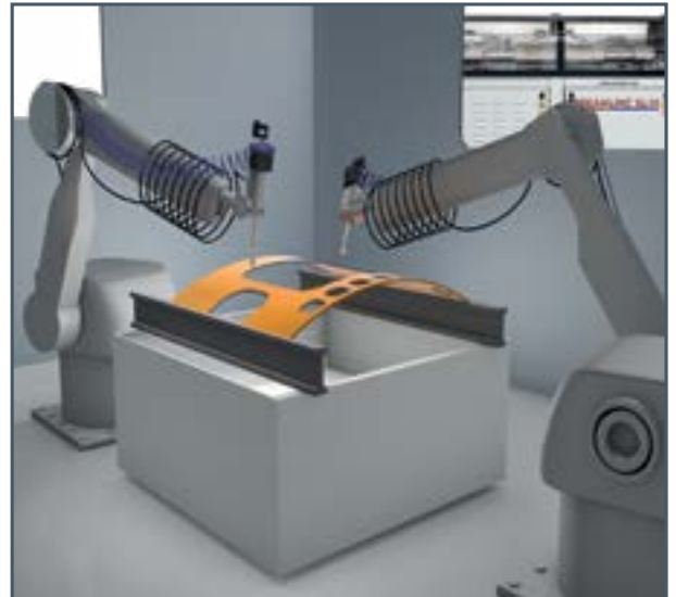
Wanna do cięcia 3D z pompą wysokociśnieniową STREAMLINE SL-VI 100
