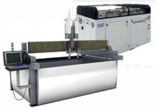
Stół do cięcia 2D z pompą wysokociśnieniową STREAMLINE SL 60 PRO 3
